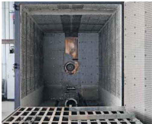
Pyrolyseofen für das thermische Entlacken.
