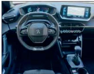
**i-Cockpit:** Bei fast allen Peugeot liegen die Instrumente über dem Lenkrad – reine Gewöhnungssache.
