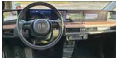
Honda e Advance: Total digital sind die Anzeigen von links bis rechts.
