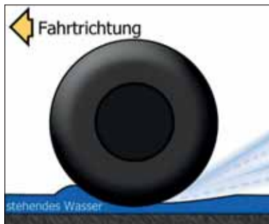
Aquaplaning: der Reifen schwimmt auf einem Wasserkeil. Er kann nicht gelenkt oder gebremst werden.
